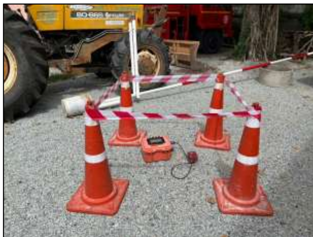
รูปที่ 4.3.3-2 แสดงการตรวจวัดความสั่นสะเทือน (บริเวณเทศบาลตำบลนาจอมเทียน)
