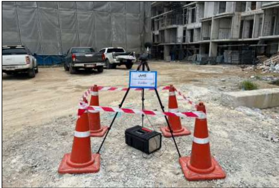
รูปที่ 4.3.2-7 แสดงการตรวจวัดระดับเสียงโดยทั่วไป (ภายในพื้นที่โครงการ)
