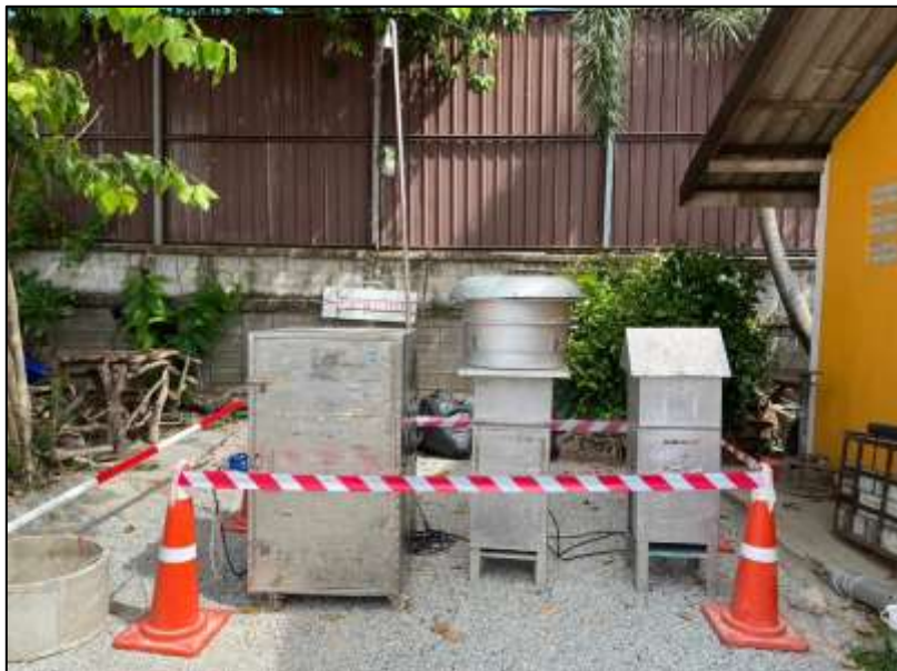
รูปที่ 4.3.1-14 แสดงการตรวจวัดคุณภาพอากาศในบรรยากาศโดยทั่วไป บริเวณเทศบาลตำบลนาจอมเทียน
